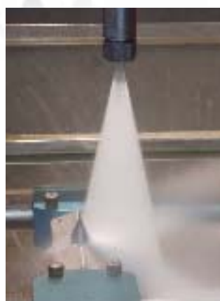
Dokumentation einer Strahldruckmessung
