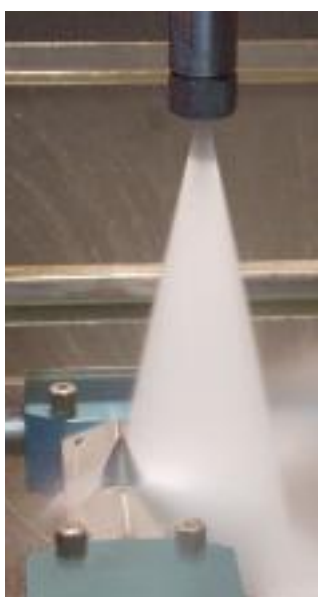
Spezial-Messeinrichtung zur Prüfung der Strahlqualität
