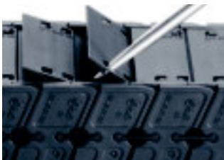
Deckel entfernen durch aufhebeln
