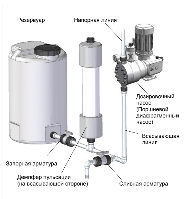
Рис. 34 Монтаж демпфера пульсации (II)
