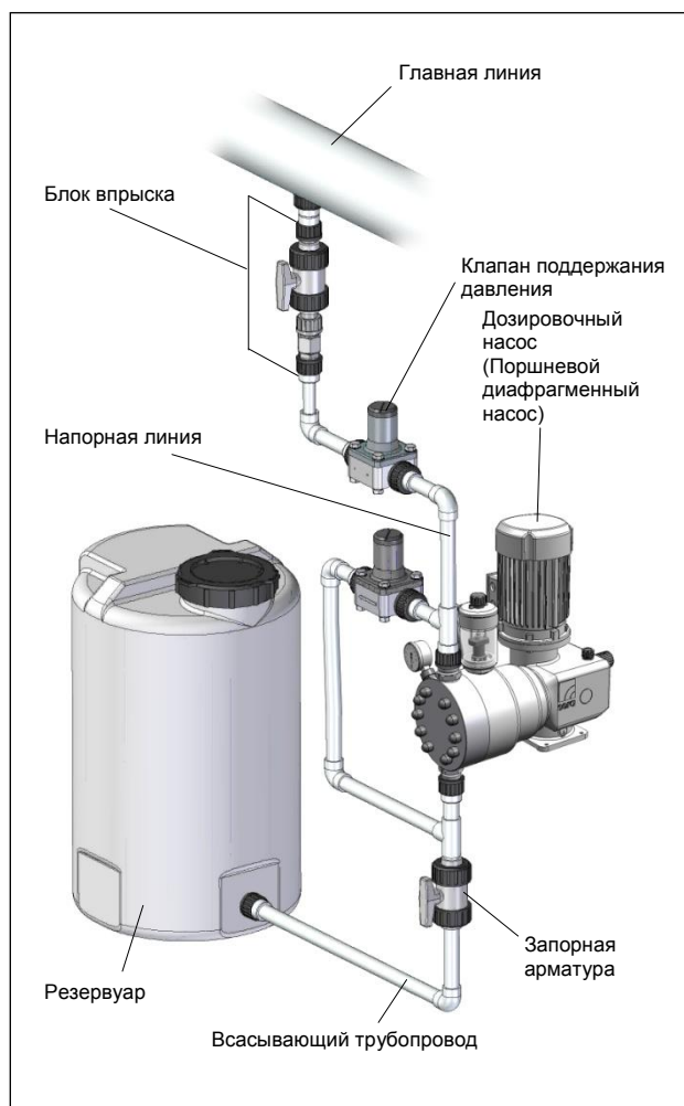
Рис. 25 Монтаж редукционного клапана
