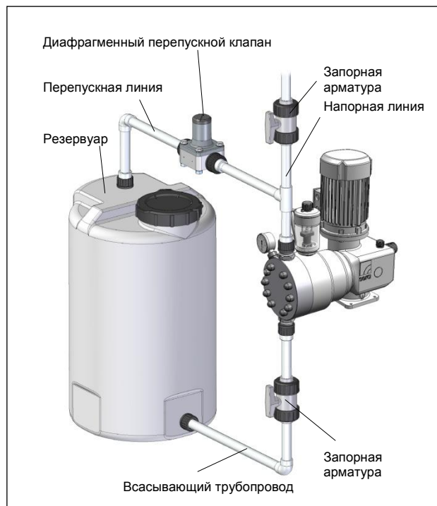
Рис. 22 Монтаж с (внешним) перепускным клапаном
