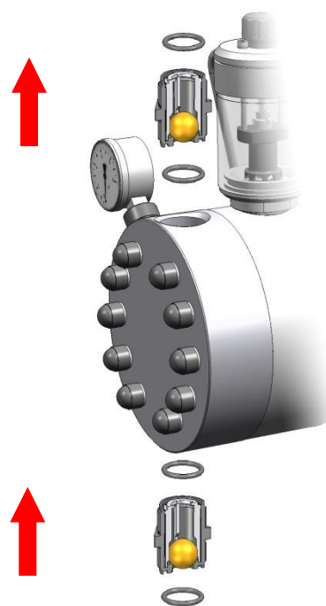
Рис. 14 Монтажное положение клапанов, направление потока
