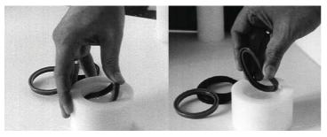
Уплотнительным кольцам (манжетам) придать форму овала и аксиально согнуть. Посадить в канавку и вдавливать по контуру, пока уплотнительное кольцо в нее полностью не сядет. У уплотнительных манжет с внутренним опорным кольцом (напр. тип \$621, \$21, и т.д.) сначала садится уплотняющая часть, а потом таким же способом опорное кольцо. Этот процесс легко можно автоматизировать при монтаже больших серий с помощью приспособлений.
