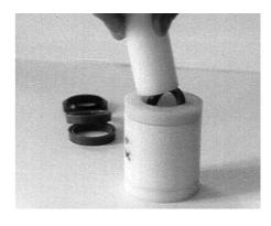
4) Вдавить уплотнение пластиковой втулкой до полной посадки в канавку
