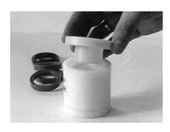
2) Вставить направляющую обойму, которая одновременно закрывает канавку для грязесъемника
