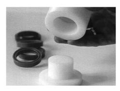
1) Крышку цилиндра для монтажа штоковой манжеты посадить на упор, который изнутри перекроет канавку на уровне ее нижней грани (заглушит)
