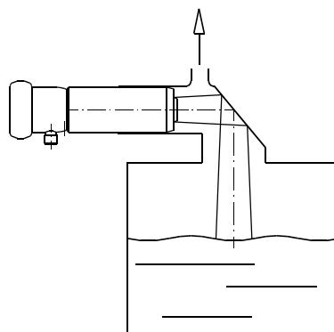
Hoher Staubanteil reduziert das Ultraschallsignal und verfälscht die Messung. Schäume werden je nach Dichte erkannt oder nicht.
