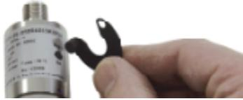
Bei kürzerer oder längerer Kontaktzeit findet keine Programmierung statt (Schutz gegen externe Magnetfelder). Unmittelbar nach der Programmierung geht der Schaltausgang in den Normalzustand (siehe unten).
