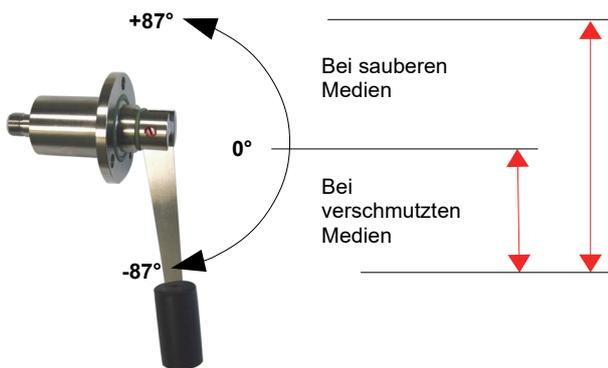
Zusätzlich zum Analogausgang ist ein elektronischer Schaltausgang vorhanden, der das Über- oder Unterschreiten einer definierten Füllhöhe signalisieren kann. Der Schalterpunkt wird mit einem mitgelieferten Magnet-Clip auf den jeweils anliegenden Füllstand programmiert. Der Zustand des Schaltausgangs wird durch eine integrierte LED angezeigt. Alternativ kann der Schaltausgang auch als Frequenzausgang eingesetzt werden.
