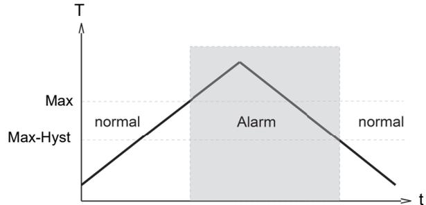
Das Wechseln in den Alarmzustand kann mit einer Schaltverzögerungszeit ( $t_{DS}$ ) versehen werden. Ebenso kann das Rückschalten in den Normalzustand mit einer davon verschiedenen Rückschaltverzögerungszeit ( $t_{DR}$ ) versehen werden.
