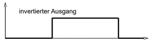
Eine optional bestellbare Power-On-Delay-Funktion ermöglicht es, den Schaltausgang nach dem Anlegen der Versorgungsspannung für eine definierte Zeit im Normalzustand zu halten.
