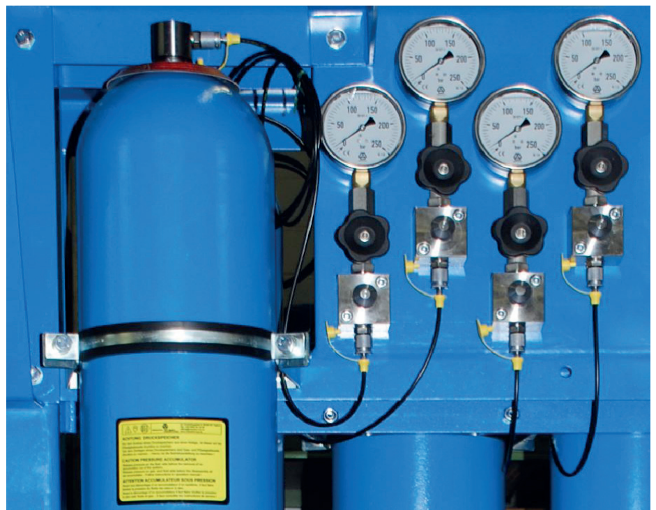
Membranspeicher mit Minimessan- schluss bzw 1/4" IG Diaphragm accumulator with mi- ni-measuring connection
