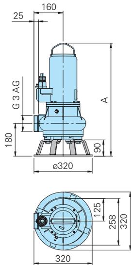
Typen mit Druckanschluss DN80
